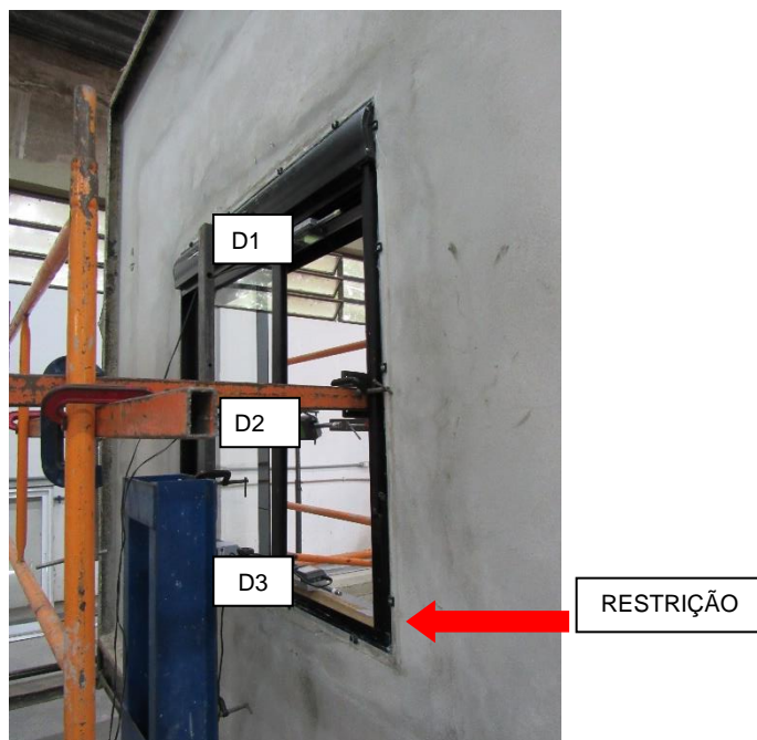
Figura 7 – Instrumentação de ensaio de resistência horizontal com um canto imobilizado
