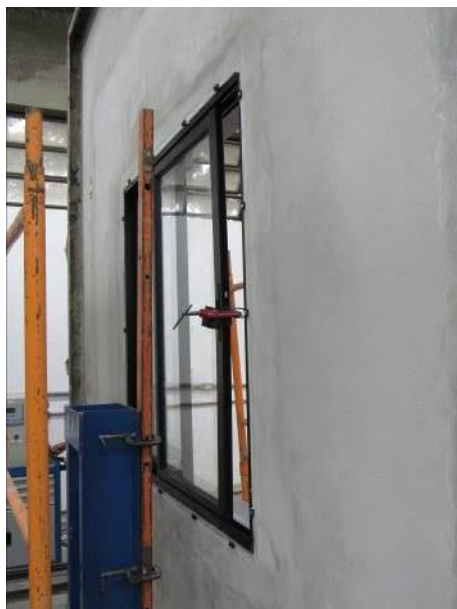
Figura 11 – Comportamento da folha interna da esquadria (400 N)
