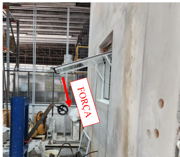
Figura 3 – Instrumentação do ensaio de arrancamento das articulações
