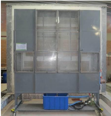
Figura 3 – Parte externa da câmara de ensaios
