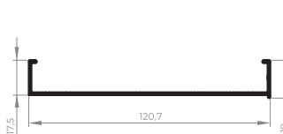
EXL-511 Marco lateral integrada 0,578 Kg/m
