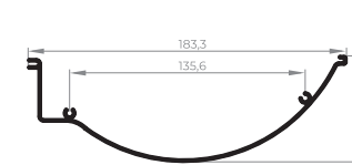
EXL-517 Tampa interna porta integrada 1,074 Kg/m
