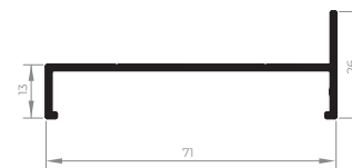
EXL-007 Marco de correr lateral liso 0,386 Kg/m
