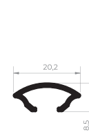
ALV-20707 Arremate externo 0,114 Kg/m
