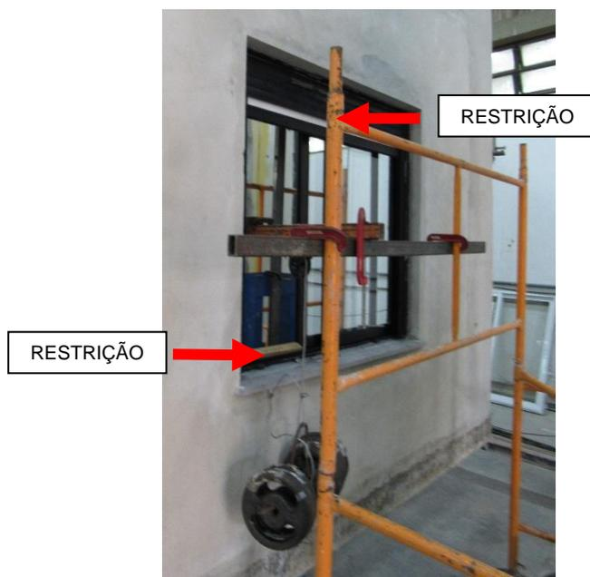
**Figura 8 – Instrumentação de ensaio de resistência horizontal com dois cantos imobilizados**
